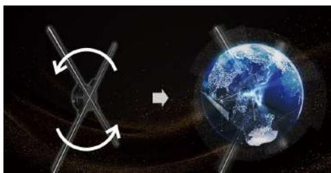
高速回転させ、光の残像現象によって空中浮遊する 3 次元映像を投影できます。
