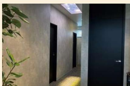
太陽光が実際に差し込んでいるかのような光の柱が、リアルの時間に合わせて差し込み具合が変化する LED 照明。
