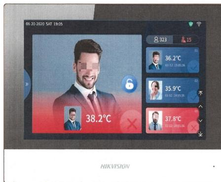
3D AI 顔認証端末と接続する事で、離れた場所からリアルタイムに検温結果をモニタリングできます。体温が高い方が来られた際はタブレットで警告音が流れます。また、検温結果は10万件のログを残すことができるため、見落としがあっても後から確認することもできます。さらに体温測定カメラとタブレットで通話ができるため、来客対応等にご活用いただけます。
