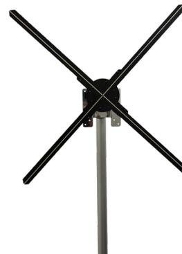
「3D Dimpact( デインパクト )」は、軽量モーターと LED 端子の並んだブレードを組み合わせて高速回転させることで、光の残像現象により、空中浮遊する 3 次元の映像コンテンツを投映します。店頭に設置することでアイキャッチ力を高める事ができ、より誘導力が高まりさらなる売り上げアップに貢献します。また、ブレードを並べ連結することで一つの大きな映像を表現することが可能です。
