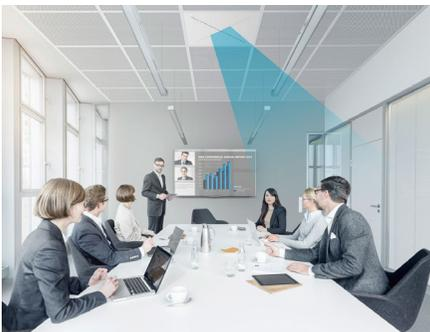
シーリングマイクとは、会議室・教室等の天井に設置し使用するマイクロホンです。マイクを天井に取り付けて使う事が出来るため、机の上のスペース全てを使える様になり、特許取得ダイナミックビームフォーミング機能により、部屋の座る位置に捉われず、歩きながらでも自由に発言できます。
